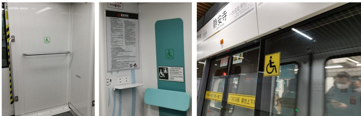
上海地铁 10 号线（左）、14 号线（右）轮椅席位以及通用设计细节、14 号线站台隔离门的轮椅标识
